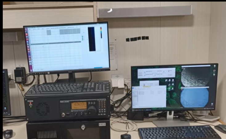
Аппаратура регистрации НЗИ и фотографирования небесного свода
