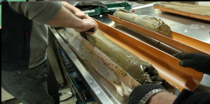
Извлечение образца из грунтовой трубы
