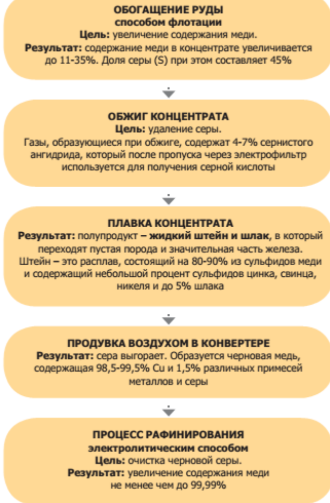
Схема 1. Пирометаллургический способ производства меди
